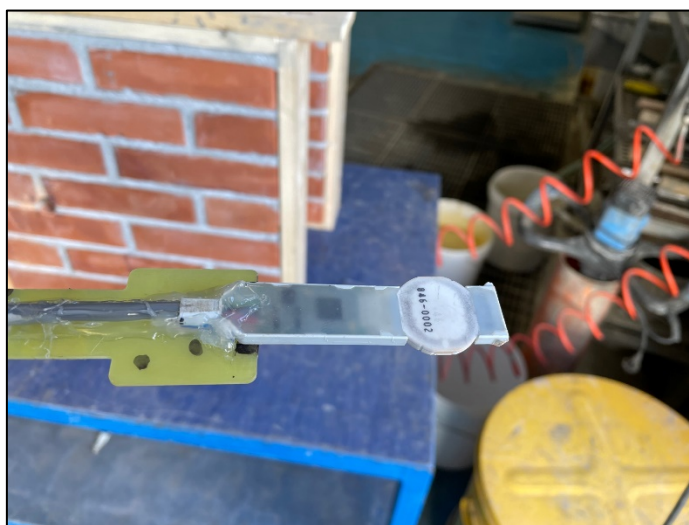
Figura 7.2.5 Secondo sistema di post-installazione sensoristica STMicroelectronics: posizionamento e incollaggio del sensore.
