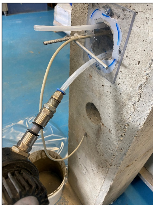
Figura 7.2.12 Terzo sistema di post-installazione sensoristica STMicroelectronics: posizionamento tubicini per iniezione della boiacca e riempimento del foro.
