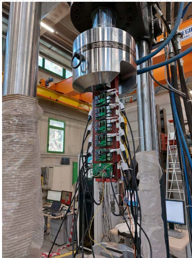
Figura 55 MTS Landmark e accelerometri pronti per la prova con forzante sinusoidale
