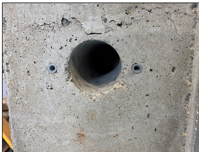
Figura 7.2.9 Terzo sistema di post-installazione sensoristica STMicroelectronics: carotaggio.
