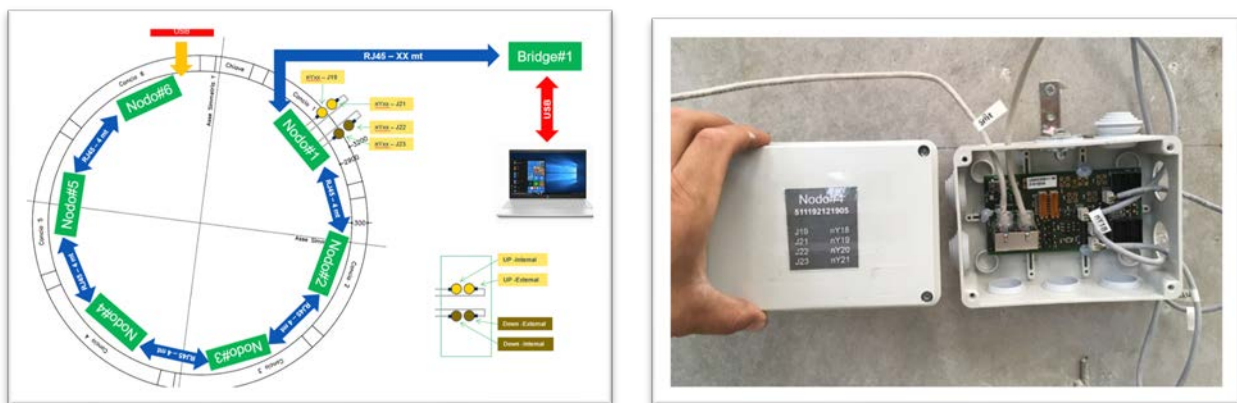
Figura 5.2.3 Foto del sistema bridge-nodo stand-alone usato nei test dell'anello di galleria presso UniRM2-Tor Vergata.
