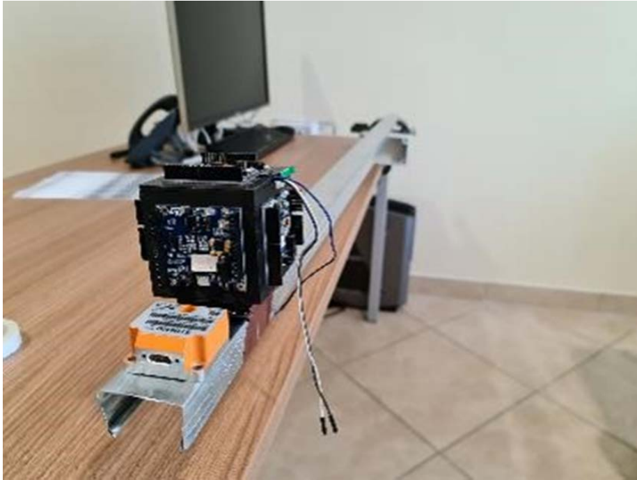
Figura 42 – Mockup a C per le prove di oscillazione; sistema di riferimento (STIM3000) e prototipo realizzato a confronto.
