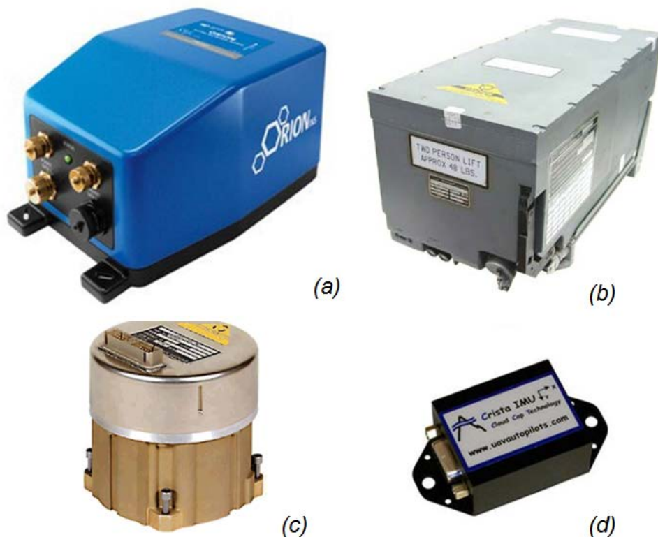
Figura 6 - 7 Esempi di sensori inerziali delle diverse categorie – (a) marine-grade (Teledyne TSS Orion); (b) aviation-grade (Honeywell 34078600-007); (c) tactical-grade (Northrop Grumman LN-200); (d) automotive-grade (Cloud Cap Crista IMU) (immagini non in scala).
