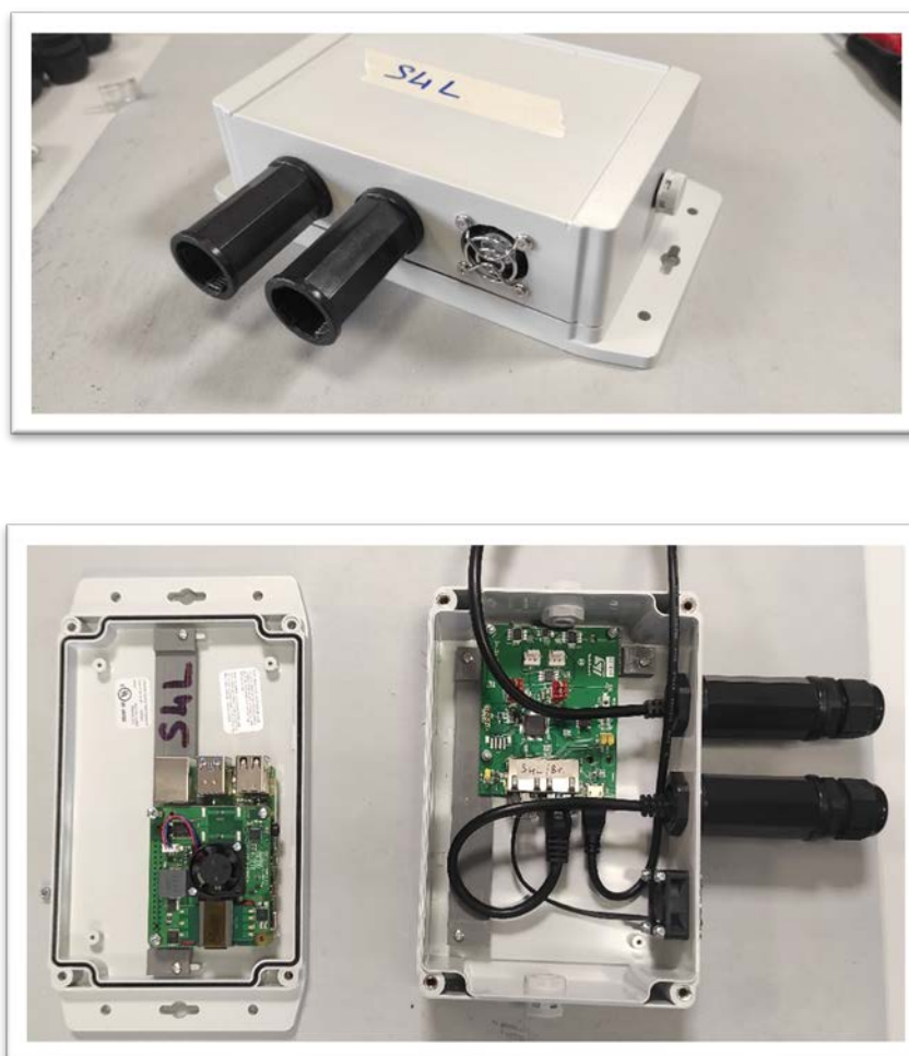
Figura 5.2.16 Foto del nodo smart, configurato come bridge, e della Raspberry Pi4 all'interno della scatola utilizzata per le installazioni dei dimostratori del progetto.
