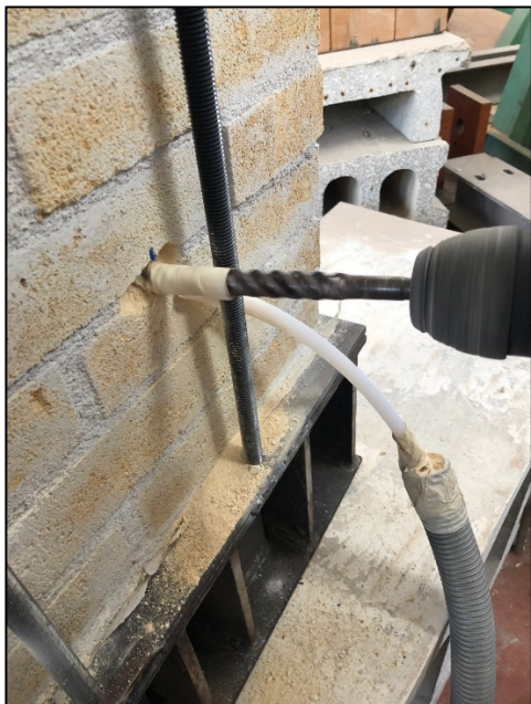
Figura 7.2.1 Primo sistema di post-installazione sensoristica STMicroelectronics: realizzazione dei fori.
