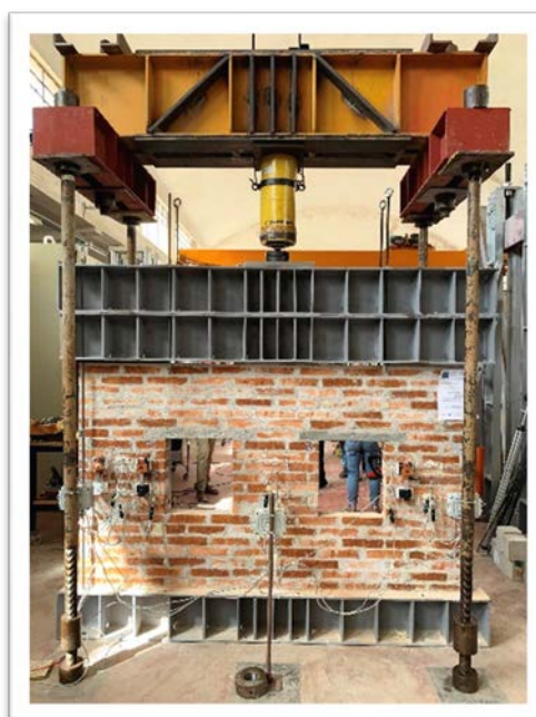
Figura 5.2.7 Sistema di monitoraggio utilizzato nei test sulle pareti in muratura presso i laboratori di UniPA.
