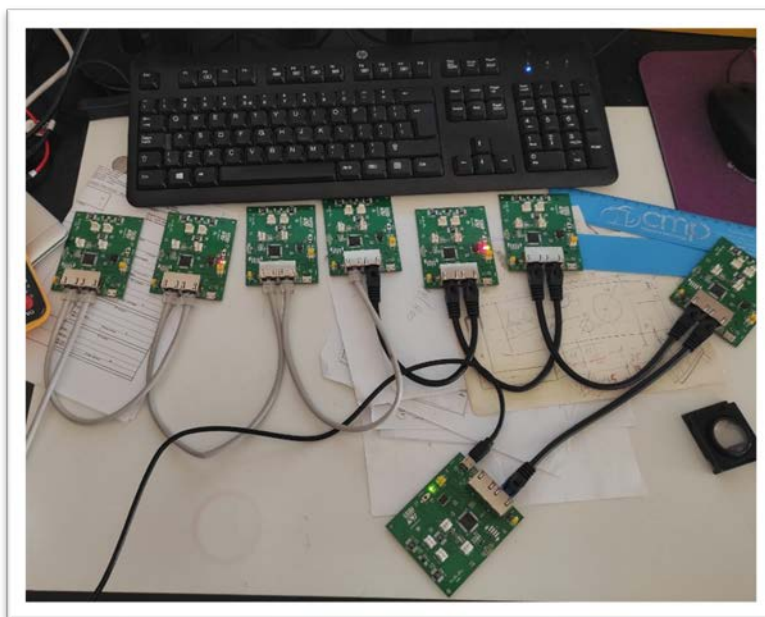
Figura 5.2.14 Configurazione multi-nodo + bridge del sistema nodo smart.
