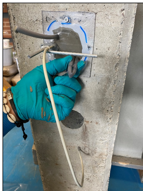
Figura 7.2.12 Terzo sistema di post-installazione sensoristica STMicroelectronics: posizionamento tubicini per iniezione della boiacca e riempimento del foro.
