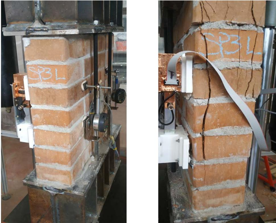
Figura 4-22. Provini in muratura con sensori post-installati sottoposti ai test di compressione fino a rottura
