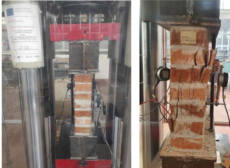
*Figura 4-26. Provini in muratura con sensori post-installati sottoposti ai test di compressione fino a rottura (seconda campagna di test)*
