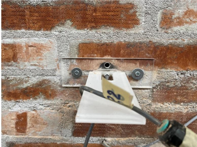
Figura 4-12. Fissaggio del sistema sul supporto
