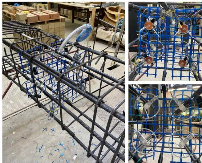
Figura 4-61. Armatura del “Provino 3” e vista delle due tipologie di sensori installati
