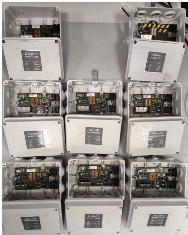
*Figura 3-8. Sistema di monitoraggio dell’anello presso UNiRM2-Tor Vergata in preparazione presso i laboratori STMicroelectronics.*
