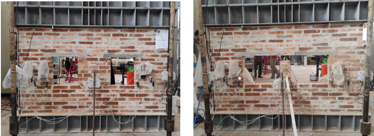
Figura 4-29. Schema di monitoraggio delle pareti in muratura durante le fasi di test
