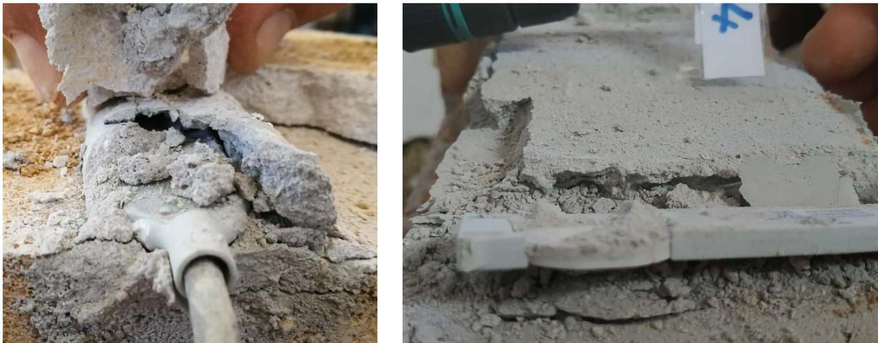
*Figura 4-24. Sensori ceramici post-installati recuperati dai provini dopo i test*
