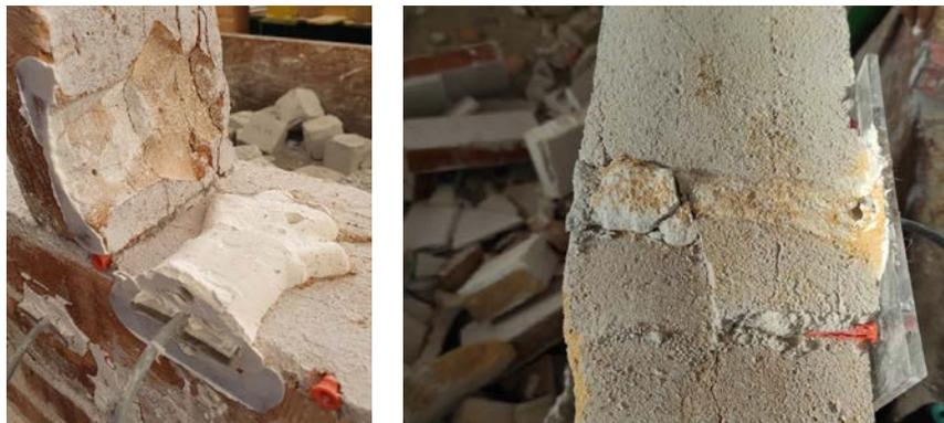
*Figura 4-27. Sensori post-installati recuperati dai provini dopo i test della seconda campagna*
