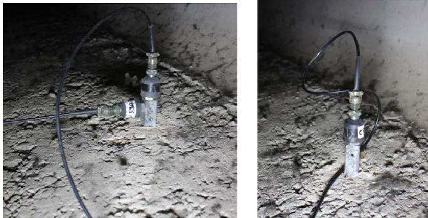
Figura 2-1. Posizionamento accelerometri all'interno del cassone
