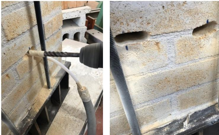
*Figura 4-7. Esecuzione fori per post-inserimento sensori*
