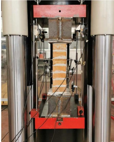
Figura 4-17. Campione sotto la pressa pronto per la prova
