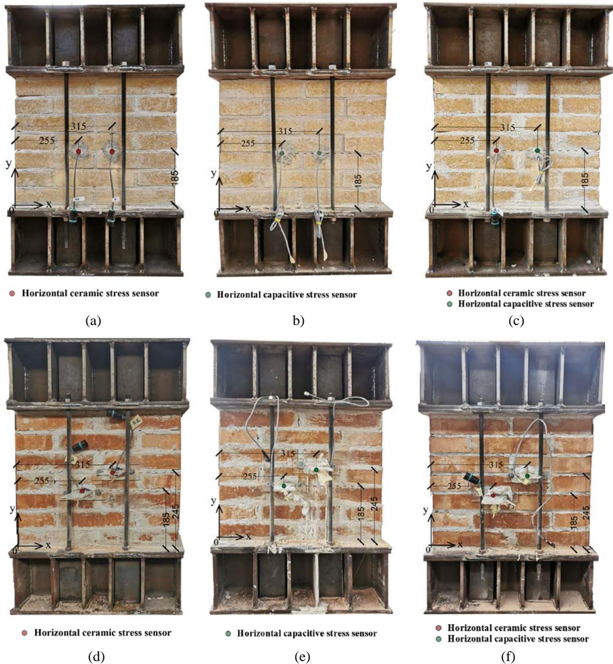
Figura 4-4. Posizionamento dei sensori (dimensioni in mm) per i due sistemi di post-installazione per la muratura di calcarenite (a, b, c) e per la muratura di mattoni (d, e, f): (a, d) schema con due sensori ceramici; (b, e) schema con due sensori capacitivi; (c, f) schema con un sensore ceramico e uno capacitivo
