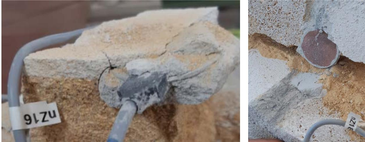
*Figura 4-23. Sensori capacitivi post-installati recuperati dai provini dopo i test*
