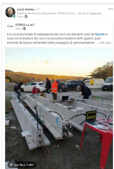
Figura- Tecnoin Spa– Condivisione Post su campagna sperimentazione su travi da ponte in c.a.p.- Progetto INSIST
