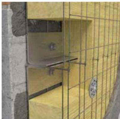
**Figura 8** Dettaglio dell’ancoraggio della tecnologia “Cappotto Armato Karma”
