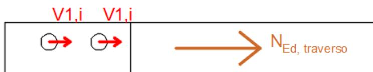
**Figura 42** Aliquota di taglio, derivante dallo sforzo normale, sul bullone del montante: schema esemplificativo
