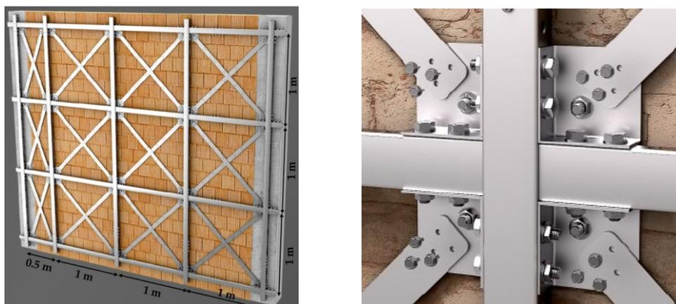
**Figura 109** Esempio di configurazione del sistema Resisto 5.9 Rube (sinistra) e dettaglio delle connessioni (destra)
