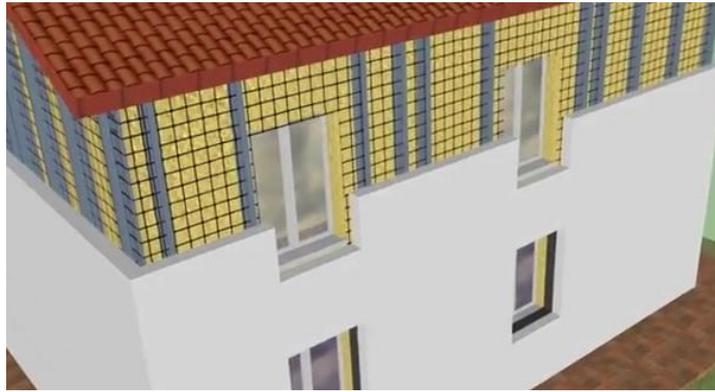
**Figura 9** Rendering della tecnologia “Sisma Coat”
